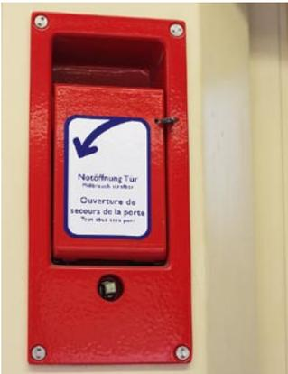
In **den Bahnen** ist der Notausstieg durch die Türen möglich. Der Hebel für die Notöffnung befindet sich neben den Türen.
